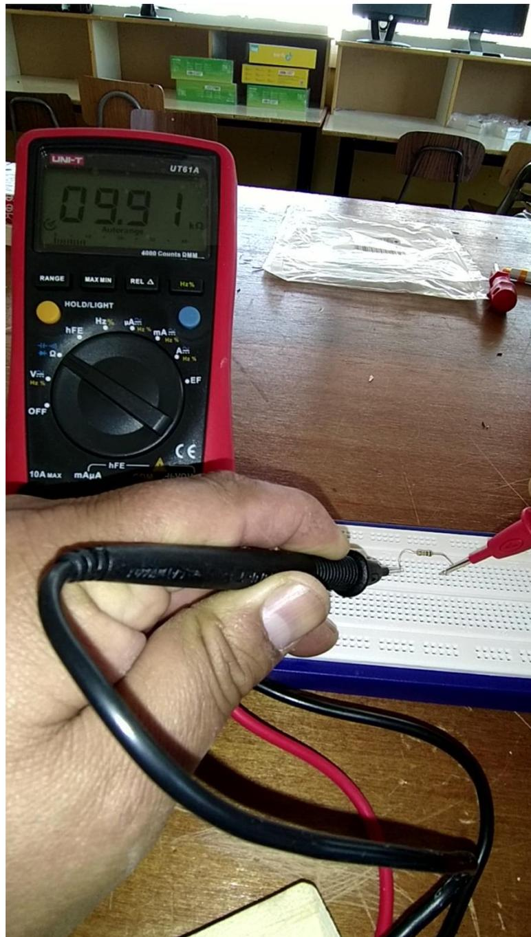
**Medición de voltaje para un adaptador de 9 voltios con multímetro.**
