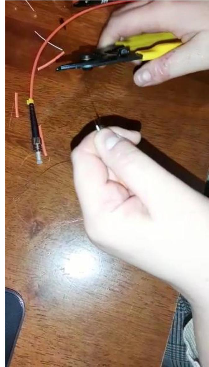
**Uso de linterna laser para verificar estado de conducción de la luz en un pigtail de fibra óptica.**
