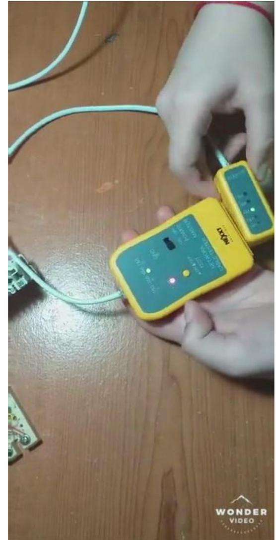
**Pruebas de continuidad de red telefónica mediante generador de tonos.**
